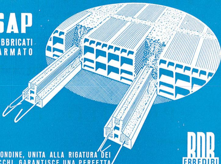
L'ANIMA A CODA DI RONDINE, UNITA ALLA RIGATURA DEI TRAVETTI E DEI BLOCCHI, GARANTISCE UNA PERFETTA ADERENZA DEGLI ELEMENTI COSTITUTIVI DEL SOLAIO FRA DI LORO, ED UNA COMPLETA MONOLITICITA' DELLA STRUTTURA
